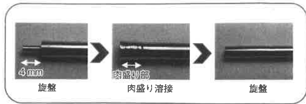
(a) 鋳抜きピンの肉盛り溶接工程
