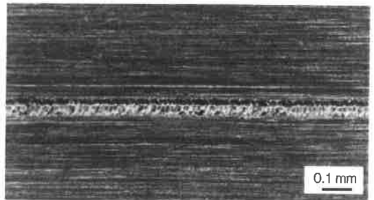
図12 シムテープの微細溶接の事例 (材質：SK 材、板厚：0.03 mm)
